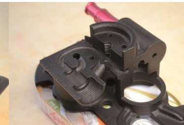
Saugergehäuse aus PA12
